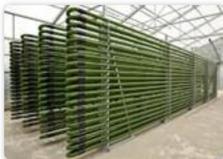
Fotobioreaktori od staklenih cijevi za uzgoj algi.
